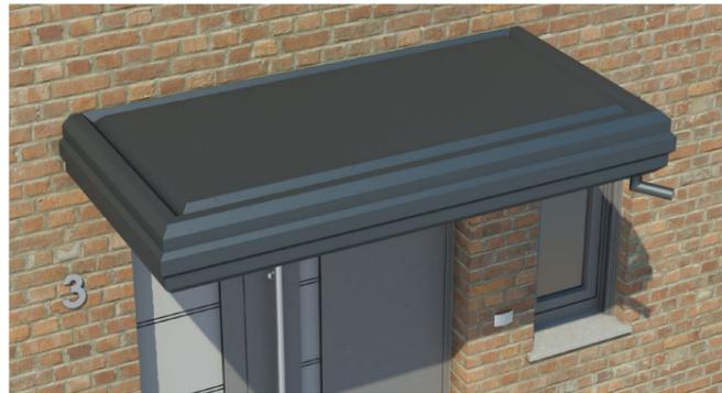
Diese Vordächer eignen sich durch ihre Maßanfertigung besonders zum Verkleiden alter Betonvordächer. Sie können aber auch durch eine Tragarmmontage an jeder Wandfläche angebracht werden. Bei diesen verschweißten Aluminium-Konstruktionen ist eine für den Betrachter unsichtbare Wasserrinne in die Dachfläche integriert. Durch diese Rinne kann das Wasser nach vorne über einen Wasserspeier oder wandseitig über ein Fallrohr abgeleitet werden.
